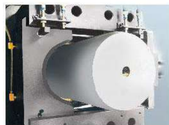
大柱夾持 Tie Bar Locking Mechanism
