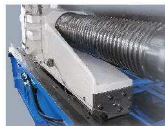
活動壁滑腳 Moving Platen Guide
